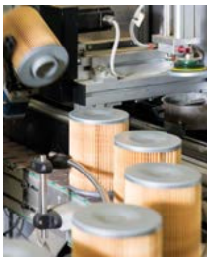
Fase di incollaggio automatica filtri spin-on
