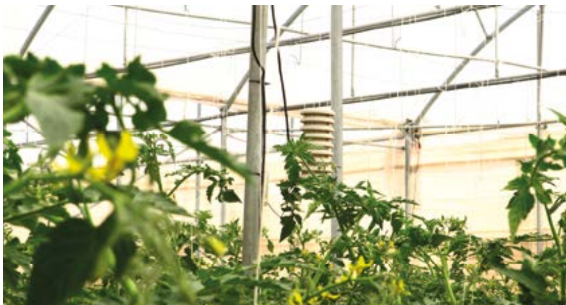
Daiki Node per il controllo micro climatico in un serra
