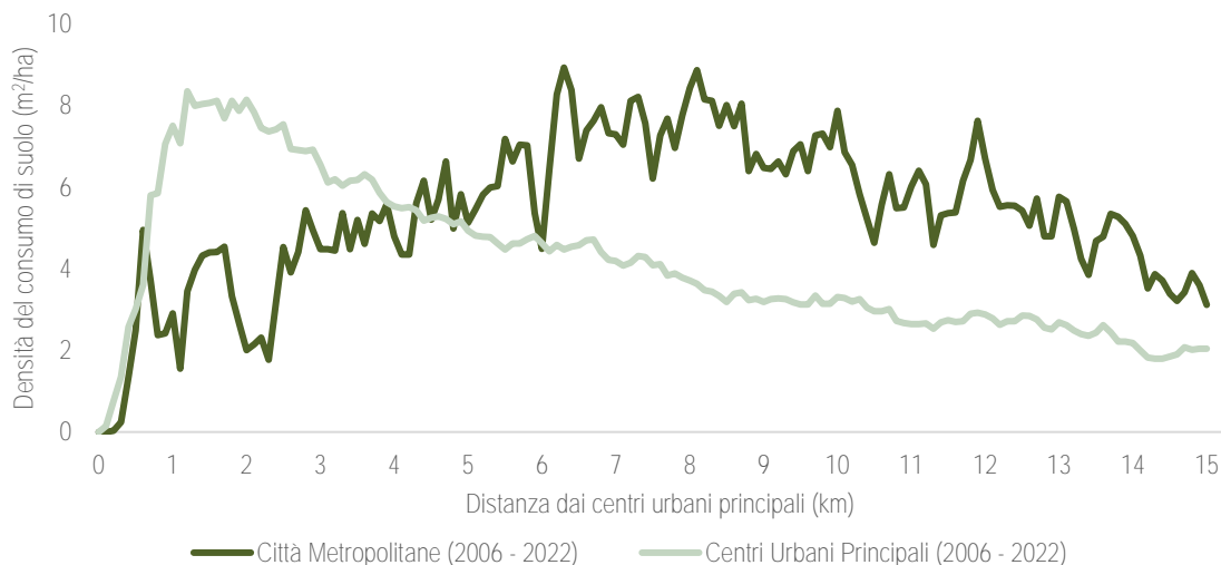
Figura 110. Densità del consumo di suolo netto annuale tra il 2006 e il 2022 in relazione alla distanza dai centri urbani principali e dalle Città metropolitane. Fonte: elaborazioni ISPRA su cartografia SNPA
