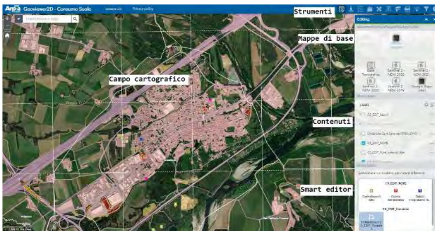
Figura 224. L'interfaccia dell'applicazione web per la fotointerpretazione. Immagine di sfondo: ESRI World Imagery (Credits: Esri, Maxar, Earthstar Geographics, and the GIS User Community)
