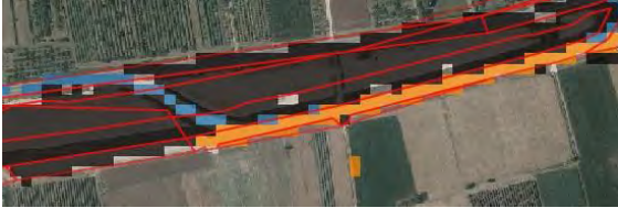
Figura 241. Classificazione delle aree di cantiere (in nero – codice 1) precedente al 2017. Solo a partire dal 2018 la strada, anche se temporanea, (in blu – codice 112) e i nuovi cantieri (in arancione – codice 122) vengono attribuiti a codici diversi a tre cifre (III livello di classificazione)
